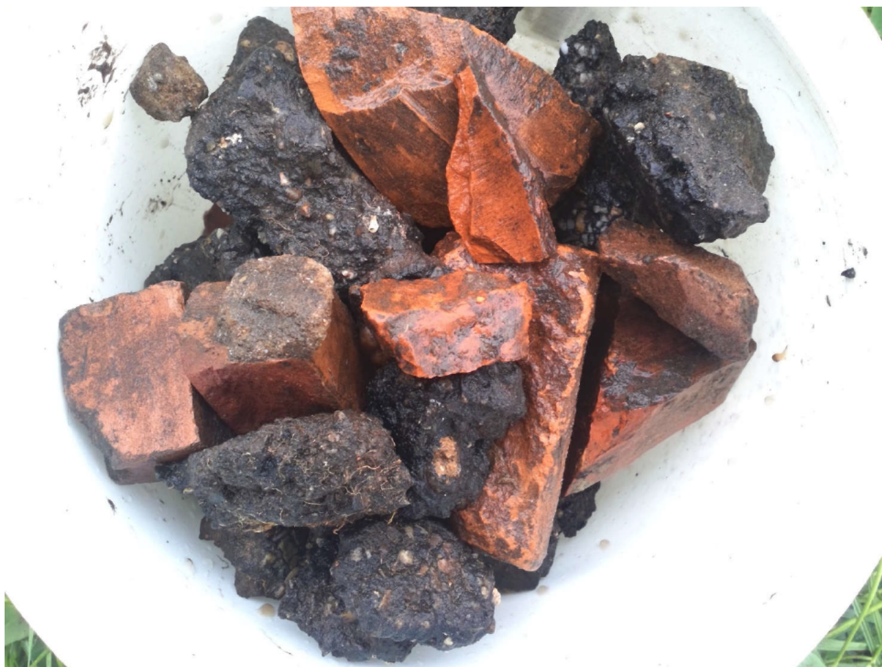
Afbeelding 4.1: Brokken asfalt en puin waargenomen op het maaiveld bij boringen 7 t/m 14.
